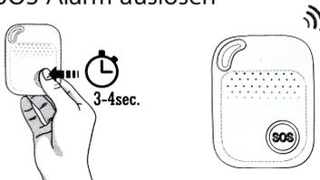
In einem Notfall, drücken Sie die SOS-Taste 3-4 Sekunden, bis Sie die Sprachansage hören, dass ein SOS-Alarm ausgelöst wird. Eine „Notruf“-SMS wird an Ihre Notfall-Kontaktnummer gesendet.
